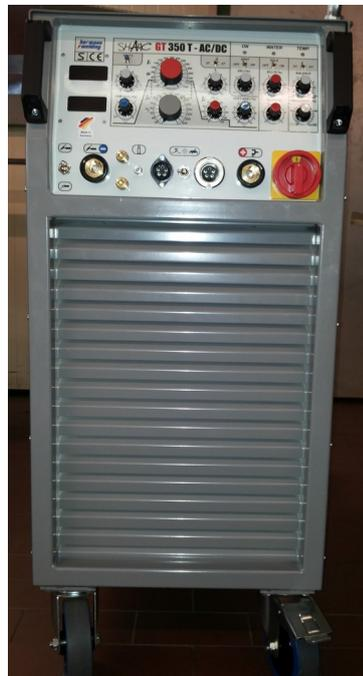
Im Vergleich mit bisherigen WIG/TIG-Lichtbögen bieten unsere Anlagen eine geringe Energieeinbringung in den Grundwerkstoff und damit weniger Verzug, bessere Flanken- und Wurzeleinfassung.
